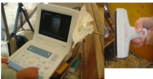
図1 超音波診断装置「HS-2100V」 プローブ：視野幅120mm、コード長3m、 周波数2MHz 走査方式：リニア走査 表示モード：Bモード 外形寸法：335mm(幅)×500mm(奥行き) ×380mm(高さ)(キーボード開時) 重量：約11kg
