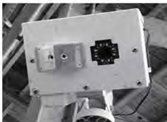
図1 遠赤外線カメラ(a)と可視カメラ(b)およびエッジコンピュータから成る新規開発のカメラシステム
